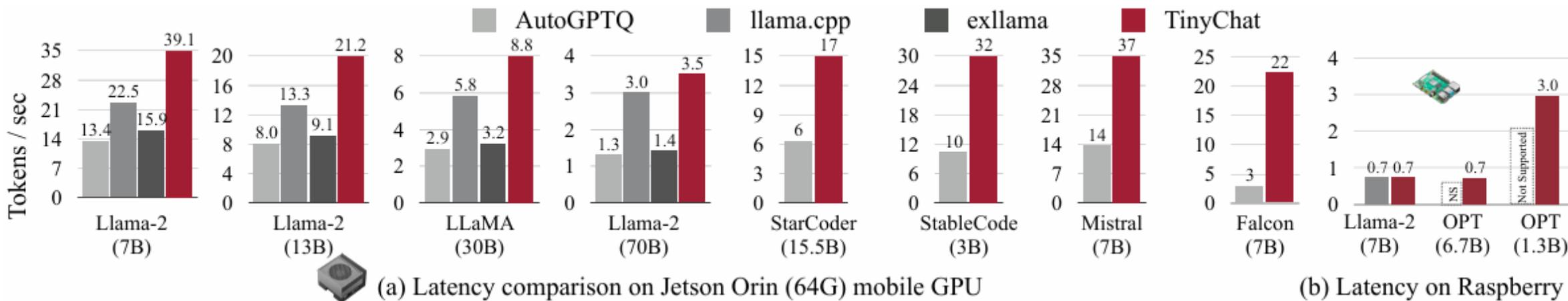
TinyChat在NVIDIA Jetson Orin上运行4位量化的Llama模型时，相较于现有系统提供了1.2-3.0倍的速度提升。它还支持多种通用和针对编码的LLM，并在处理这些工作负载时至少比AutoGPTQ快2.6倍。
