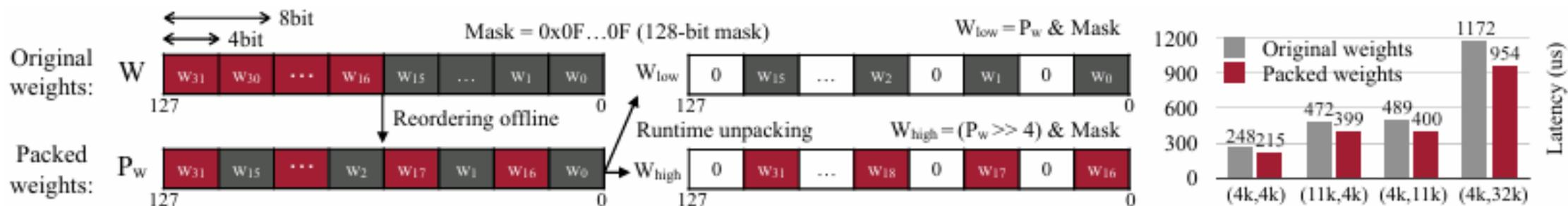
针对具有128位SIMD单元的ARM NEON的SIMD感知权重打包。原始权重被重新排序并打包，以便与位宽对齐，从而使权重可以在运行时使用AND运算和位移操作与128位掩码进行解包
